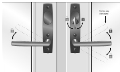
Tryck i änden för att öppna ventilen
