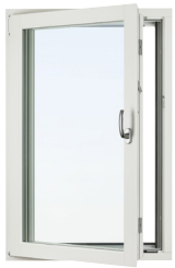
Sidohängt fönster Inåtgående 3-glas isolerruta Rund profil
