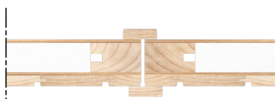
Horizontalsnitt slagport träregelstomme, (inre)
