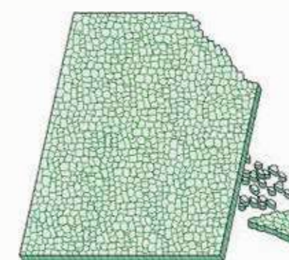
Härdat säkerhetsglas finfördelas i massor av små delar med liten risk för skärskador.
