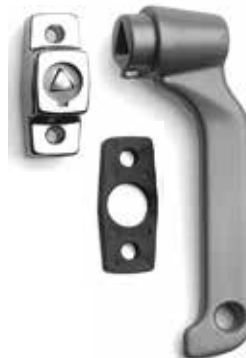
Löstagbart handtag med underläggsdel och säkerhetsanordning Assa 805. Används till trapphusfönster för att undvika obehörigt öppnande och som barnsäkerhet.
