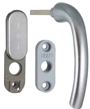
Löstagbart handtag med täcklockslucka och underläggsdel. Används till bland annat brandklassade produkter, trapphusfönster för att undvika obehörigt öppnande och för barnsäkerhet.
