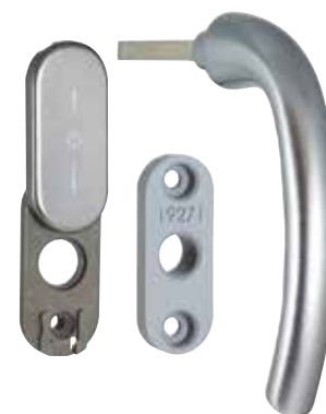
Löstagbart handtag med täcklockslucka och underläggsdel. Används till bland annat brandklassade produkter, trapphusfönster för att undvika obehörigt öppnande och för barnsäkerhet.
